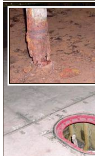
Einfüllrohre und Tankdeck vor und nach der Sanierung (Fotos unten). – Das sieht nach Arbeit aus: Nagender Rost am Aufbau und zerlegte Maschinenteile (Bilder oben).
