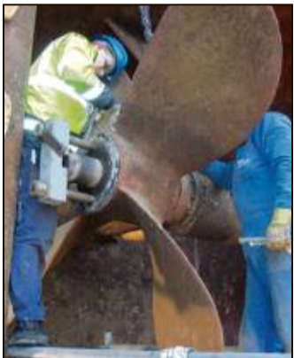
Auch die Schwanzwellen des Tonnenlegers wurden in der Werft gezogen und bearbeitet.
